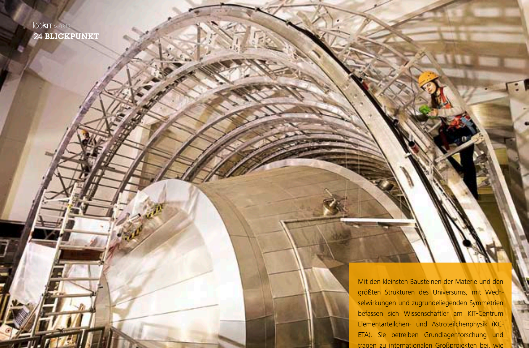
Dr. Susanne Mertens auf einer der 15 konzentrischen Spulen des Luftspulensystems (Radius ca. 6 m) des KATRIN-Experiments
