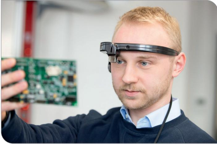
Eine Augmented-Reality-Brille ermöglicht, dass der digitale Assistent versteht, was der Nutzer sieht. So können Mensch und Maschine in Echtzeit kommunizieren. (Fotos: Tanja Meißner/KIT)
