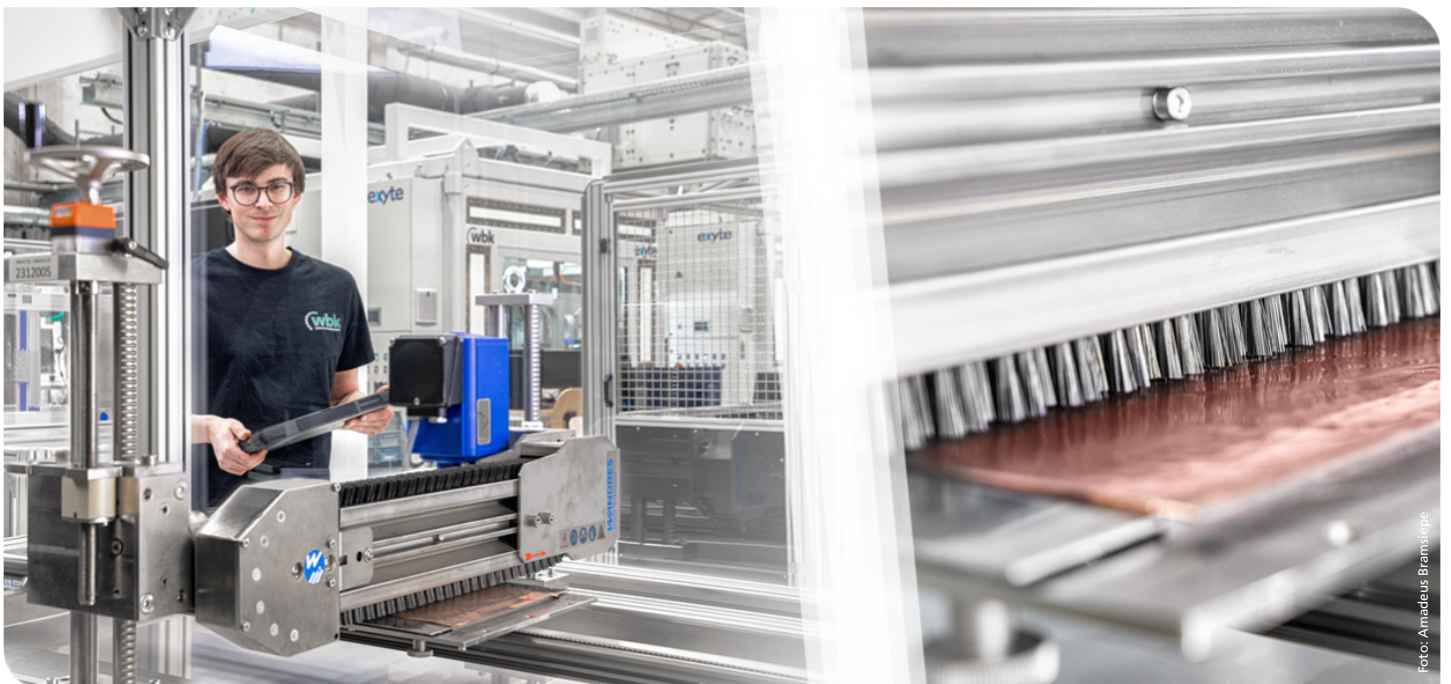
Versuchsaufbau für das direkte Recycling von Batterieelektroden mithilfe einer Schwertbürste.
